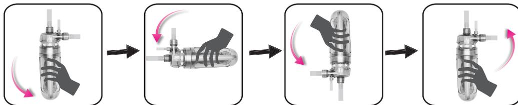
9. 本品内の空気を全て排出させたら CO<sub>2</sub> レギュレーターシステムをオンにして調節して下さい。
